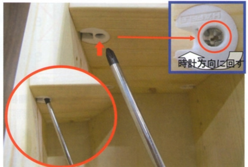
⑫ 棚板の裏から先端が2番のプラスドライバーでネジを締めて固定します。(側板に向かってやや斜めの角度から差し込みます。)
