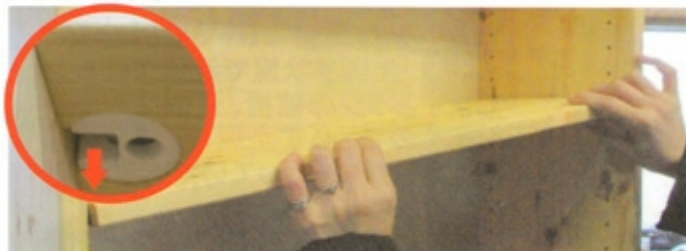
⑨ 反対側同様カムロックを180度程時計方向(右回し)に回してしっかり締めて固定します。
