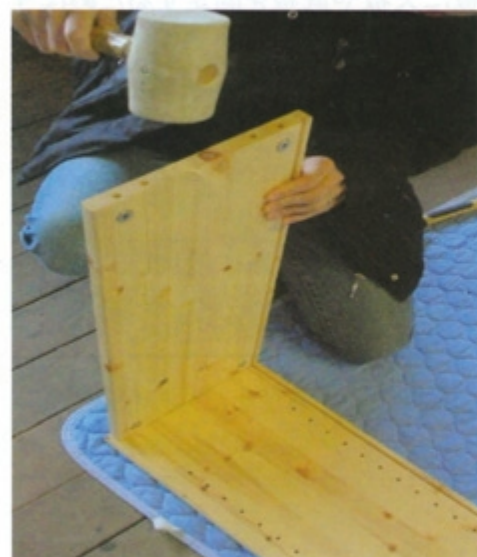
⑤ 差込が硬い場合はゴムハンマーなどで叩いて差し込みます。(差込が甘いとカムロックで固定できません。)差し込まれましたらカムロックを時計方向(右回し)に回してしっかり締めて固定します。
