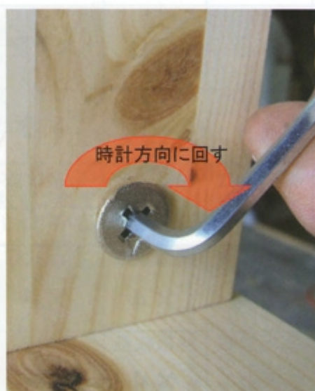
⑤ 差込が硬い場合はゴムハンマーなどで叩いて差し込みます。(差込が甘いとカムロックで固定できません。)差し込まれましたらカムロックを時計方向(右回し)に回してしっかり締めて固定します。
