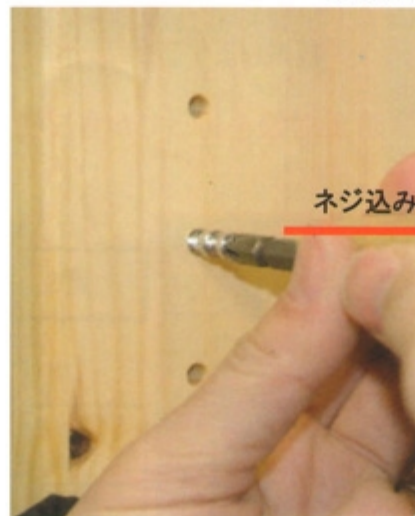
⑩ 本体が組み上がりましたら棚板を固定します。側板のお好きな位置の穴に棚板用受けネジをねじ込みます。
