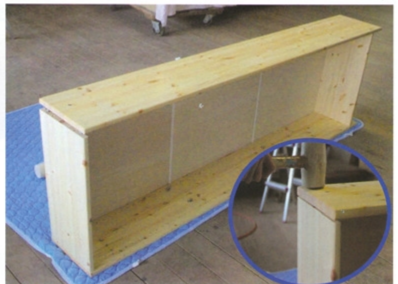
⑧ 背板を溝にはめ込みましたら反対側の側板を組みます。背板を側板の溝にはめながら押さえ込みます。(背板が溝にきっちりハマっていないと側板を固定出来ませんのでご注意ください。)
