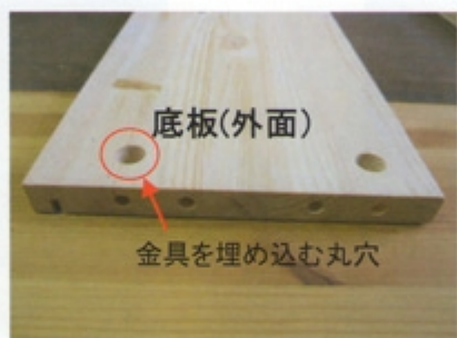
② 天板と底板を確認します。背板用溝と金具を埋め込む丸穴が同じ面にあるのが天板、違う面にあるのが底板になります。
