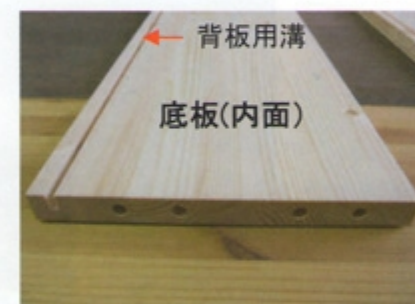
② 天板と底板を確認します。背板用溝と金具を埋め込む丸穴が同じ面にあるのが天板、違う面にあるのが底板になります。
